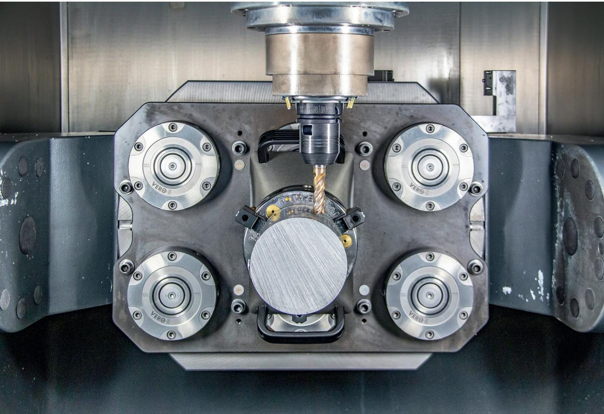
1 Diese Schwenkbrücke ist mit sechs Vero-S NSE3 138 Nullpunktspanmodulen mit Konusverschluss ausgerüstet. Über die Schnittstelle kann etwa das stationäre 3-Backen-Handspannfutter Rota-S plus 2.0 schnell gerüstet werden © Schunk
