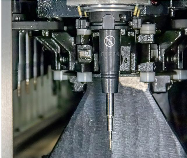
2 Mit dem weltweit ersten Hydro-Dehnspannfutter in genormter Wärmeschrumpfkontur, dem Tendo Slim 4ax, bearbeitet Vitronic seine Werkstücke mit höchster Präzision © Schunk
